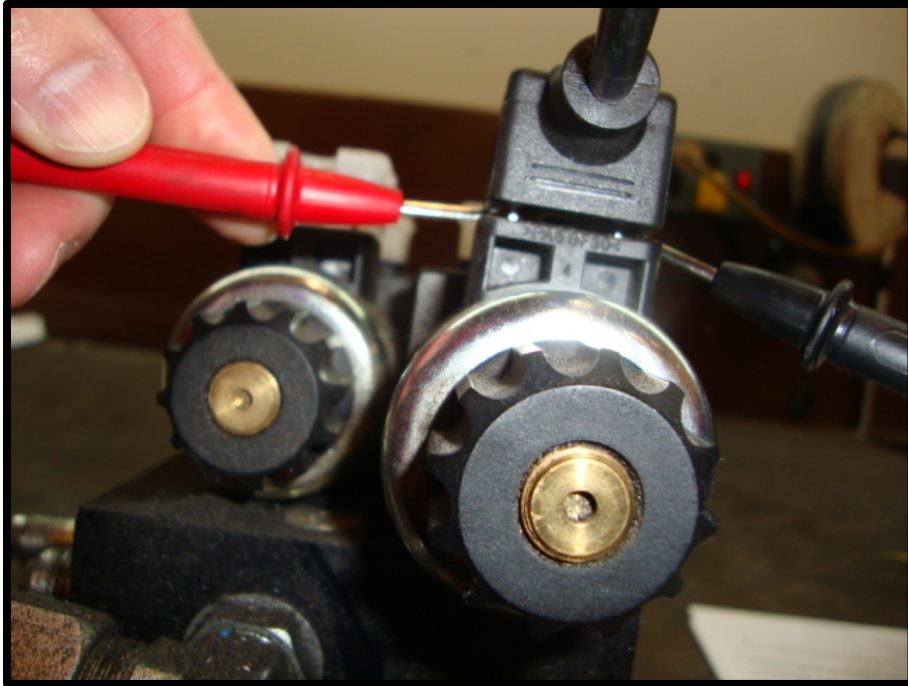
Fig. 8.4 Checking Din Plug Voltage
